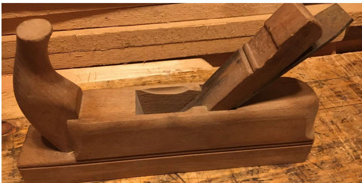
I primi sbozzini (originariamente denominati in inglese *roughing planes* e solo in seguito *scrub planes*) erano costruiti in legno di faggio o altri legni duri. Nelle vecchie botteghe, si era soliti utilizzare come sbozzino una vecchia pialla in legno da finitura la cui suola, a causa dell'usura, si era abbassata e la cui bocca si era allargata. Ad oggi, è forse il tipo di pialla in legno che ha maggiormente resistito all'avvento delle pialle in metallo.
